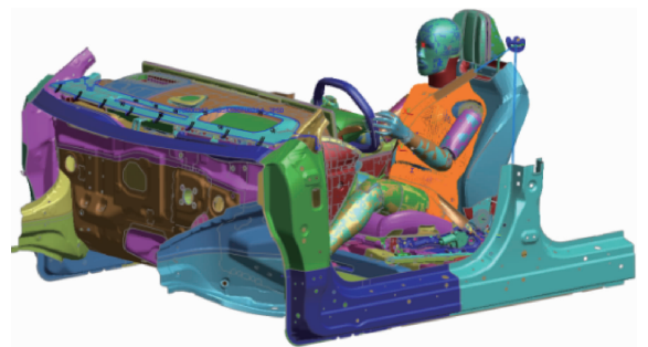
图 1 100% 正面碰撞工况仿真模型 Fig. 1 Simulation Model of 100% Frontal Collision
